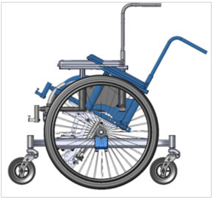
Figure 9: Les restrictions d'inclinaison sur une configuration à roues médianes avec des plaques d'extension.
