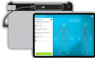
L'empreinte est, par la suite, numérisée grâce à un scanner et au logiciel TechMed 3D. Le lissage numérique s'effectue à notre usine.
