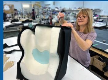
Notre robot CNC 6 axes façonne ensuite, avec précision, un bloc d'uréthane injecté. Il ne reste plus qu'à nos techniciens à ajouter les composantes posturales avant l'essayage.
