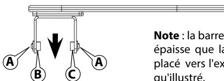
**Note :** la barre de blocage **B** est plus épaisse que la **C**, celle-ci doit être placé vers l'extérieur de la table, tel qu'illustré.
