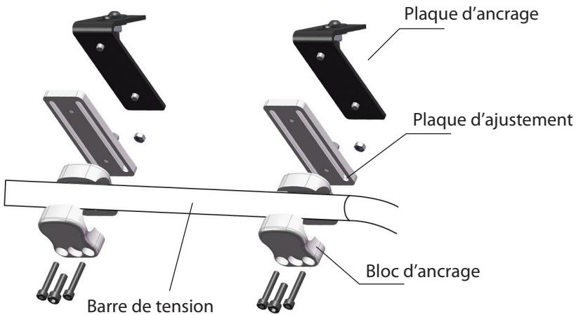
Les blocs d'ancrage se fixent sur une barre de tension. ( Bloc disponible en ø25mm + réduction pour ø22mm et ø19mm.)
