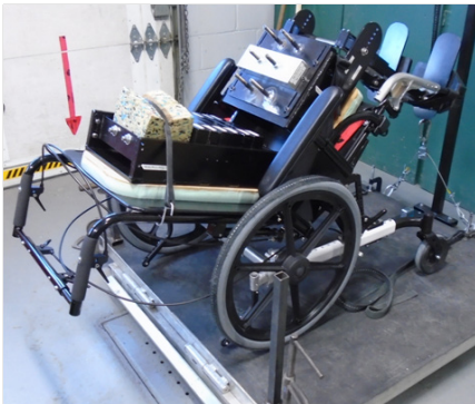
Figure 5: Test de stabilité vers l'arrière avec un dossier inclinable sur la base de positionnement NEOX.
