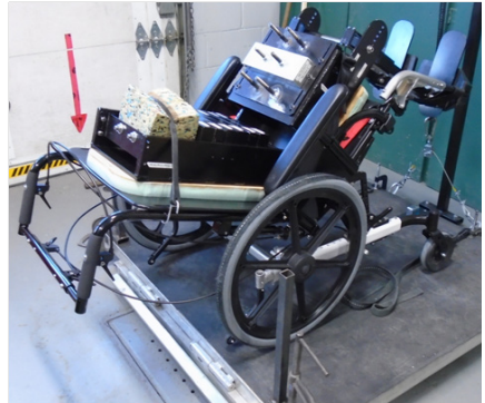
Figure 5: Test de stabilité vers l'arrière avec un dossier inclinable sur la base de positionnement NEOX.
