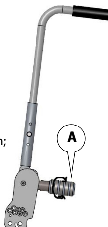
Figure 24: Ajustement de la tension du dossier dynamique
