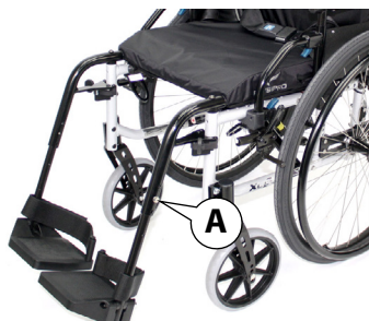
Figure 32 : Ajuster la longueur de l'appui-pied
