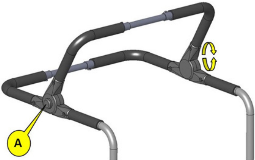
Figure 27 : Ajustement en angle de l'extension de poignée de poussée
